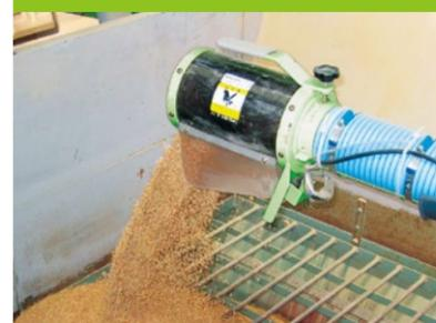
強力な排出力を生み出すハイパワーモーターを使用。2モーター方式で毎分280キロの排出が可能です。
