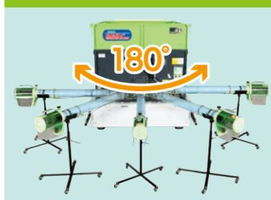
着脱式のフレキシブルホースで左、右180度排出が可能。粉の張り込み作業がスムーズに行えます。
