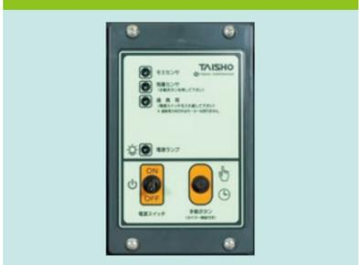
モーター停止はセンサーで自動コントロール。無人運転で安心して作業が行えます。
