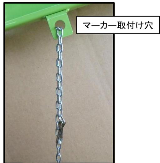
3. コンベアの左右共、同じ要領で取り付けて完成です。マーカは、並べ作業の前に機体の向きを合わせる時、目印としてお使い下さい。
